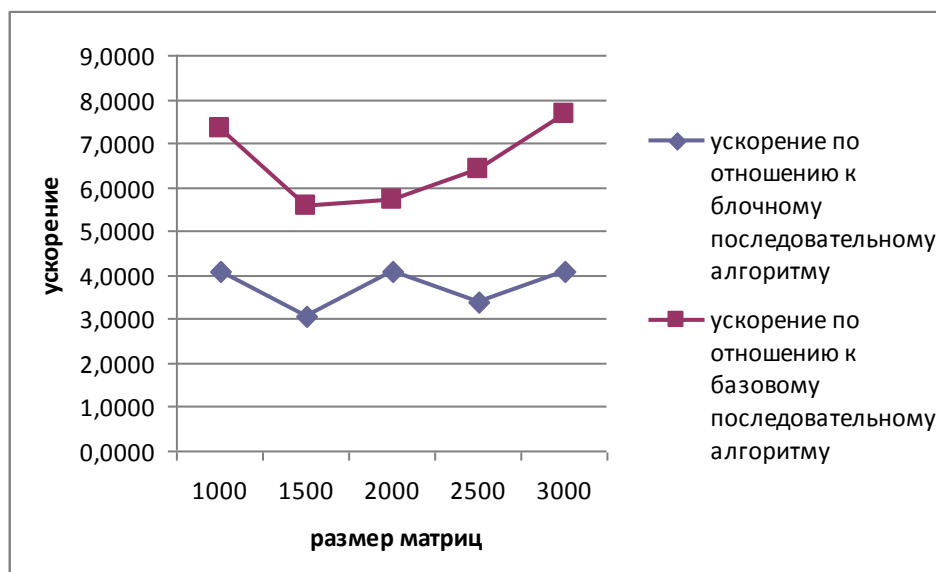
Рис. 7.15. Ускорение параллельного блочного алгоритма умножения матриц, ориентированного на эффективное использование кэш-памяти, в зависимости от размера матриц
